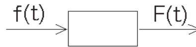
Figura 10.9: Sistema que transforma la señal f en F . F es la respuesta del sistema frente al estímulo f .
